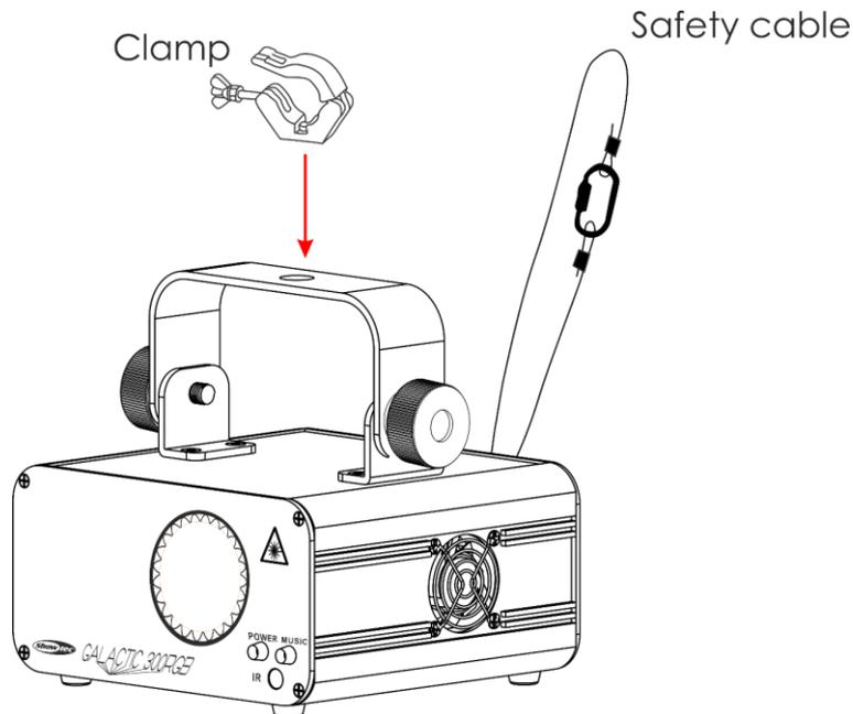
Der Galactic kann auf dem Boden einer flachen Bühne positioniert werden oder mit einer Schelle an einem Traversenrahmen befestigt werden.
