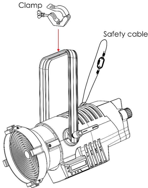
Le TF-300 Fresnel peut être soit placé sur une surface au sol dégagée, soit monté sur n'importe quel type de structure avec un collier.
