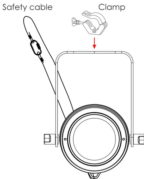
La unidad Cameleon Spot Q4 se puede colocar en un suelo plano de escenario o instalar en cualquier tipo de *truss* mediante una abrazadera.
